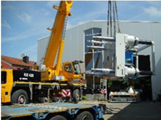
Die einzelnen Transporteinheiten wurden mittels ortsansässigen Autokran verladen auf die einzelnen Tieflader und innerhalb von Deutschland zum Kunden transportiert.
